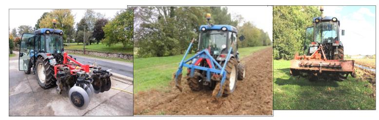
**Exemple de préparation**: cover-crop pour nettoyage du sol, sous-soleuse pour travailler le sol en profondeur, rotavator pour travail superficiel et dérouleuse pour la pose du paillage. Ce travail reste à la charge du porteur de projet.
